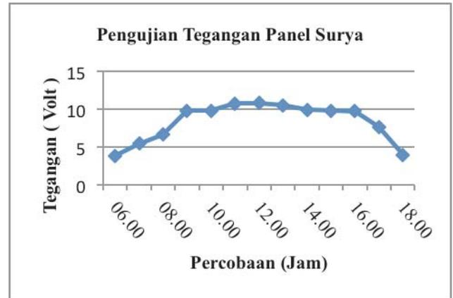
Gambar 7 Grafik Tegangan Panel Surya
