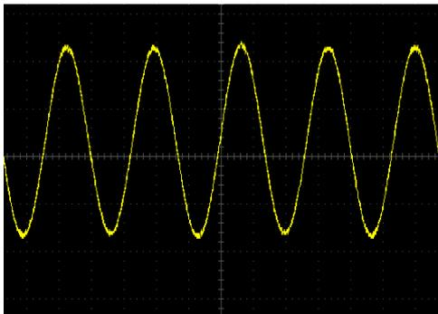
Gbr. 9 Tegangan output Generator dengan kecepatan putar generator 2765 RPM berupa tegangan AC.
