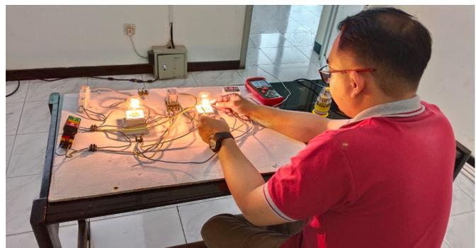
Gbr. 4 Percobaan Termostat Pengontrol Suhu
